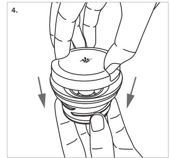
**DE** Zum Zusammensetzen des Deckels beide Teile fest zusammendrücken. Achtung: Der Deckel hat eine Verdrehsicherung und lässt sich nur auf zwei Positionen wieder zusammen setzen.
