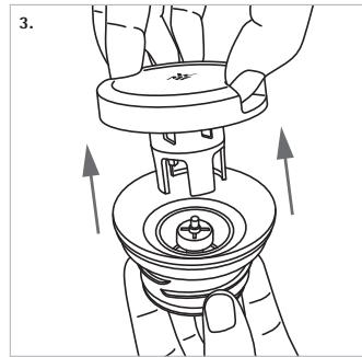
**DE** Halten Sie die Push-Platte in den Griffmulden fest und ziehen Sie diese nach oben ab. Der Deckel ist in zwei Teile zerlegbar.
